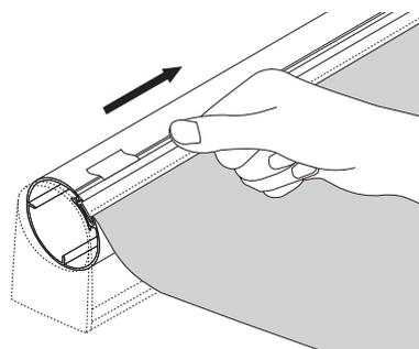
**9** 本体をブラケットに取付けます。セットバーの外側をブラケットの仮止めフック(解除ボタンのある側)に引っかけてください。本体を奥に「カチッ」と音がするまで押し上げてください。
