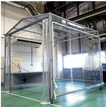
粉塵飛散防止 ビニールカーテン
